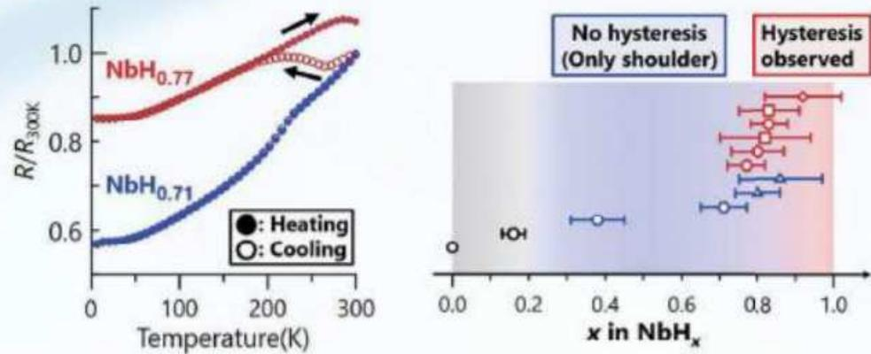
ニオブ水素化物薄膜の成長方位と薄膜内水素の含有量を制御し、室温よりも高い領域にまで及ぶ抵抗の温度ヒステリシスの観測に成功。
